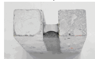
Abbildung 3 – RoadSaver Silicone – Nicht standfester Prüfkörper – Während des Flüssigkeitstests
