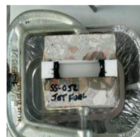
Abbildung 3 – RoadSaver Silicone – Nicht standfester Prüfkörper – Während des Flüssigkeitstests
