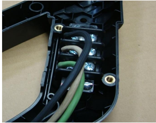
图 6.17 接线端子块接线
