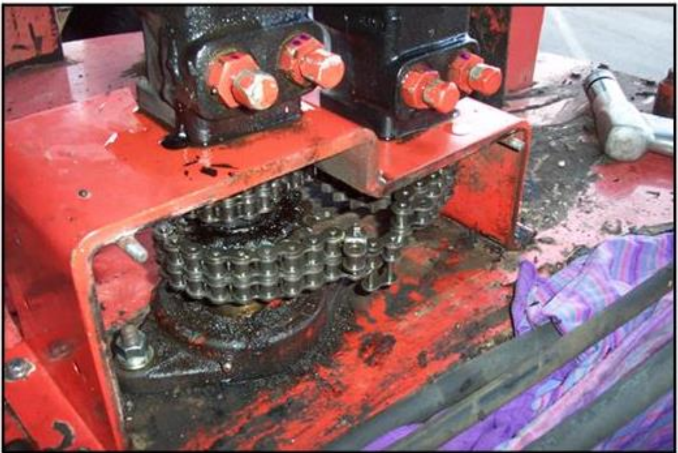
图 6.13 搅拌器轴上的链驱动连接
