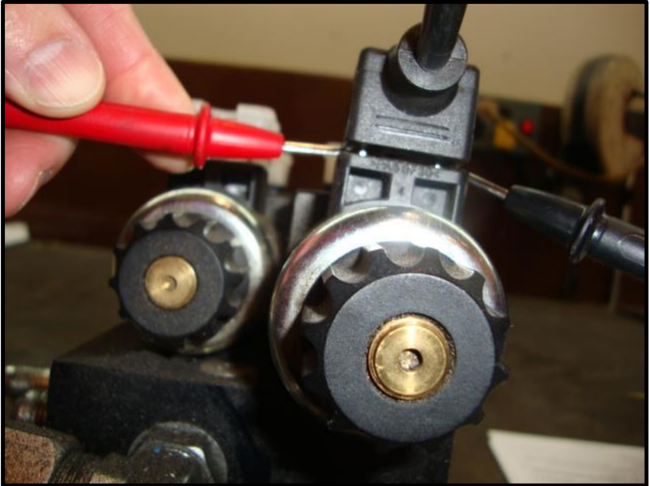
图 8.4 检查 DIN 式插头电压
