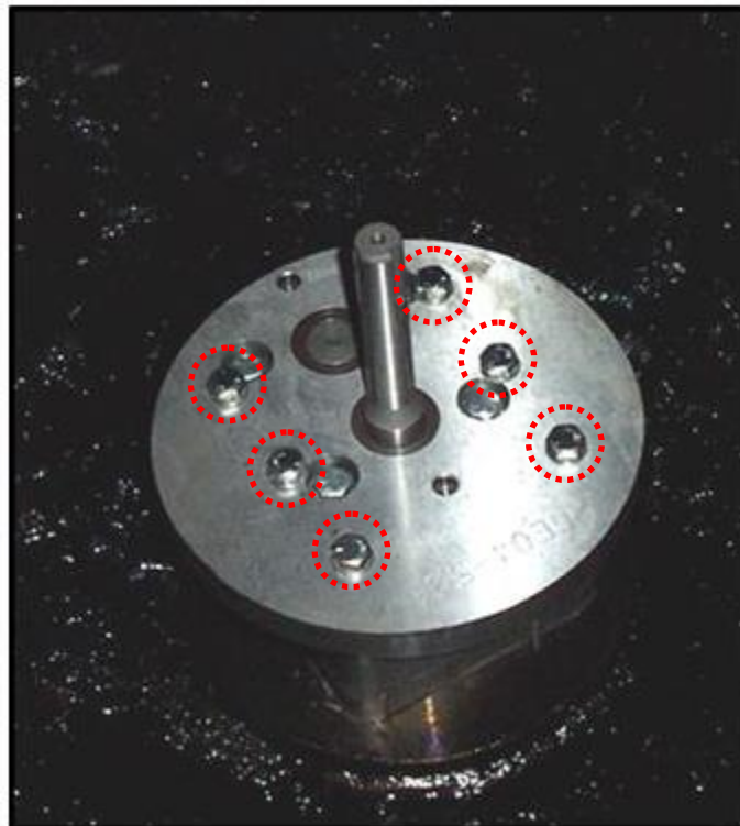
图 6.6 拆下材料泵上的螺栓
