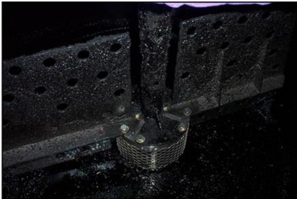
图 6.10 搅拌器的驱动轴和桨叶的安装
