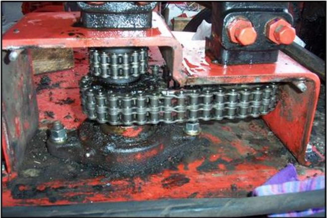
图 6.14 搅拌器链条张紧步骤
