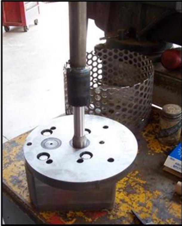
图 6.8 材料泵的驱动轴正确安装在材料泵上
