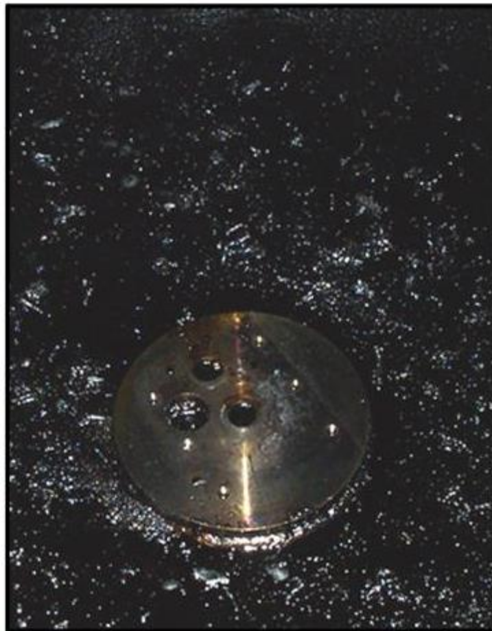
图 6.7 材料泵安装板的清洁
