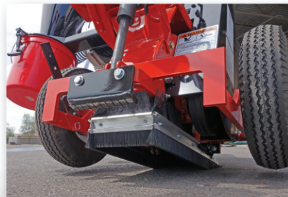
已安装好的刀头处扬尘防护罩
